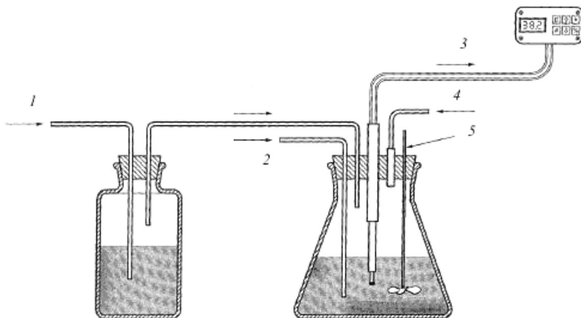
1 – подача азота через чистую посуду, содержащую петролейный эфир; 2 – вход для основного обезвоженного тетра-*n*-бутиламмониум гидроксида; 3 – оптический зонд, подключенный к колориметру; 4 – вход для ввода растворителя жира и образцов жира; 5 – перемешивающее устройство
